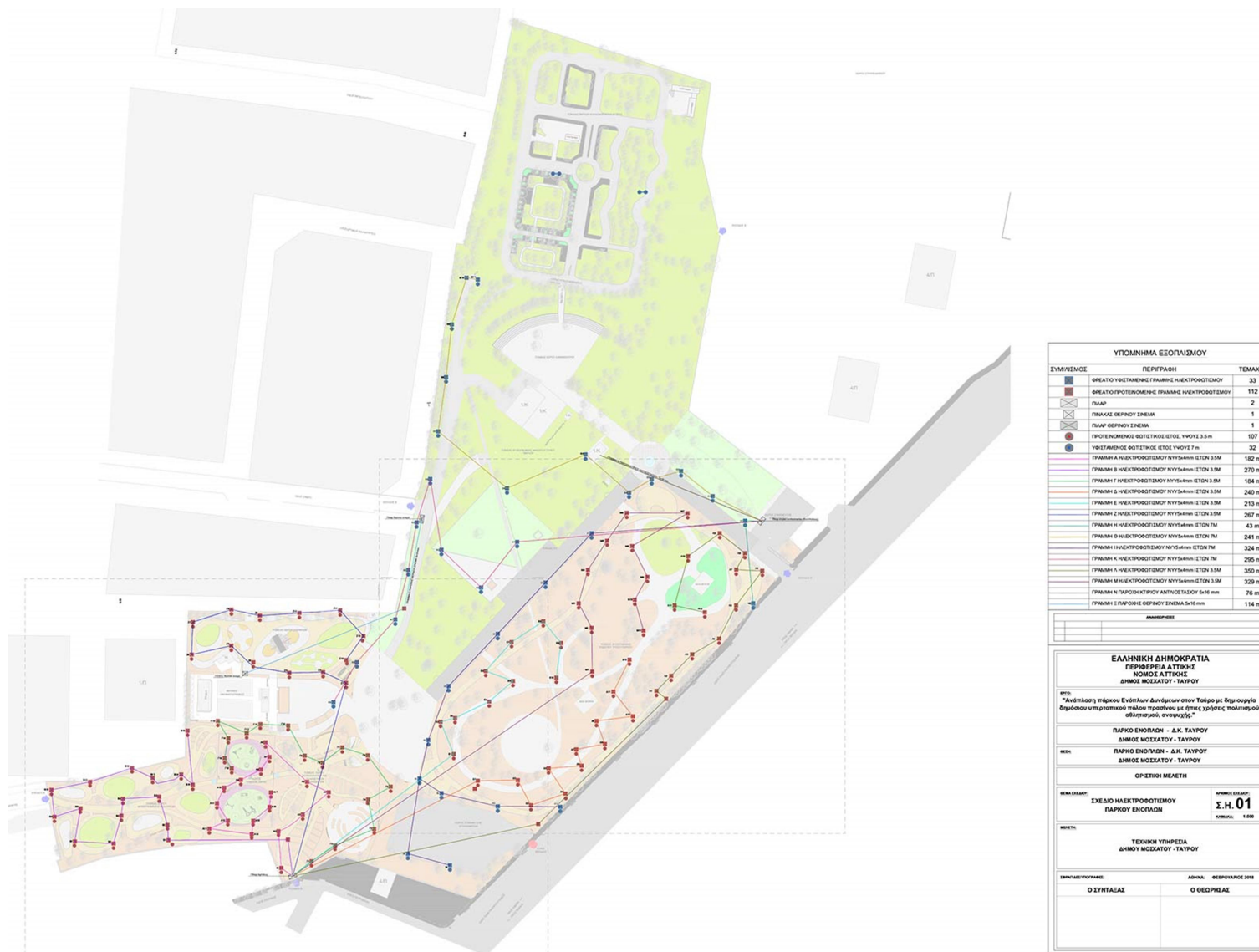
Εικόνα 55: Σχέδιο ηλεκτροφωτισμού πάρκου Ενόνισσων Δυνάμεων
