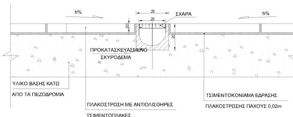
Σχήμα 1. Λεπτομέρεια Τομής επέκτασης πεζοδρομίου με αντίθετη κλίση απορροής ομβρίων και χρήση καναλιού με σχάρα για τη συλλογή των ομβρίων.
